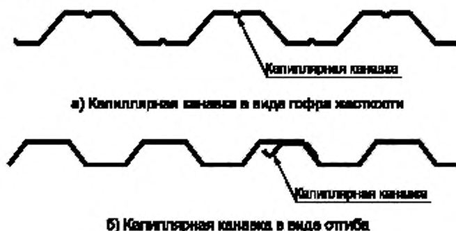
Рисунок 3 — Основные виды капиллярных канавок
